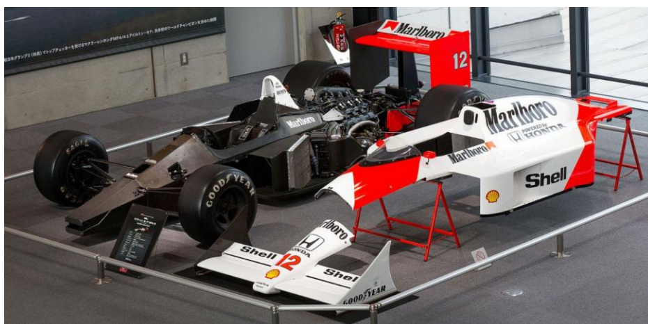
Obrázok 10 – KARBÓNOVÁ KAROSÉRIA A MONOKOK, McLaren MP4-4, r. 1988
