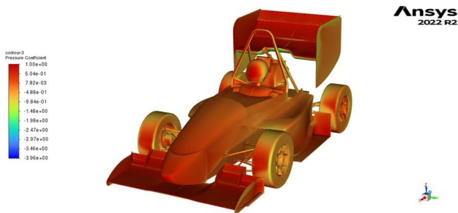
Obrázok 86 – simulácia – rozloženie tlaku 1
