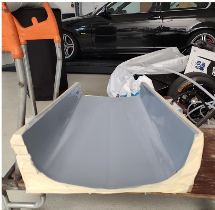
Obrázok 108 – povrchová úprava formy
