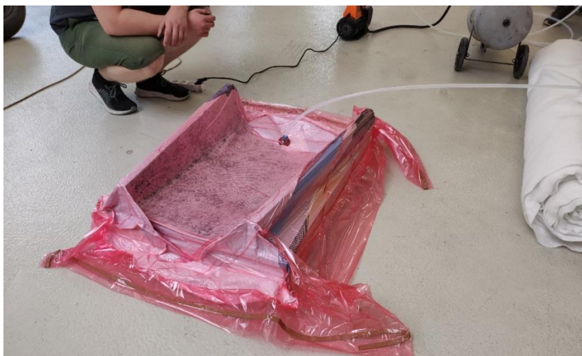
Obrázok 110 – proces vakuovania
