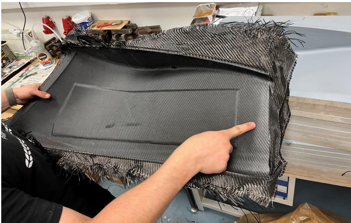
Obrázok 111 – surový laminát s vnútornou výstuhou
