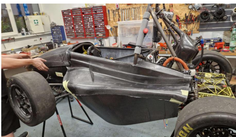
Obrázok 112 – úprava kapotáže voči rámu
