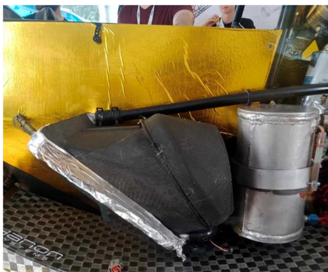
Obrázok 48 50 – chladič a olejová nádoba –ľavá strana
