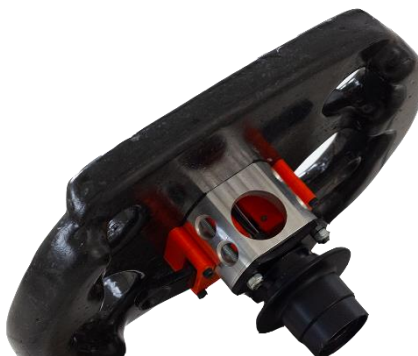
Obrázok 56 volant z forged karbonu, FS08
